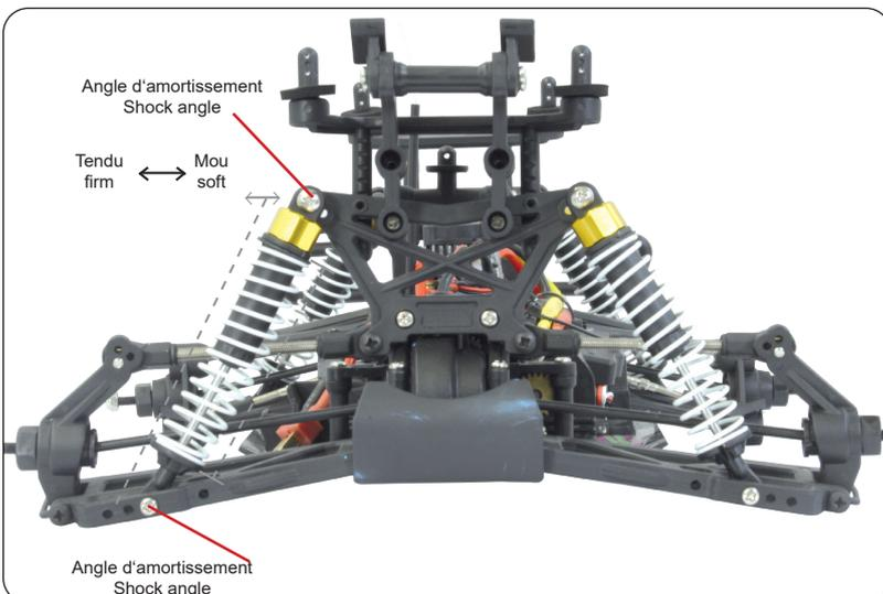
**Angle d'amortissement mou / ferme avant et arrière**
