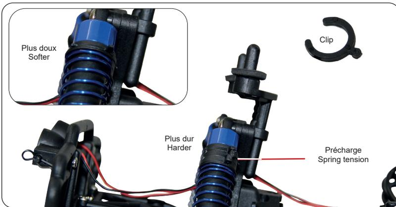
**Précharge du ressort dur / souple avant et arrière**
